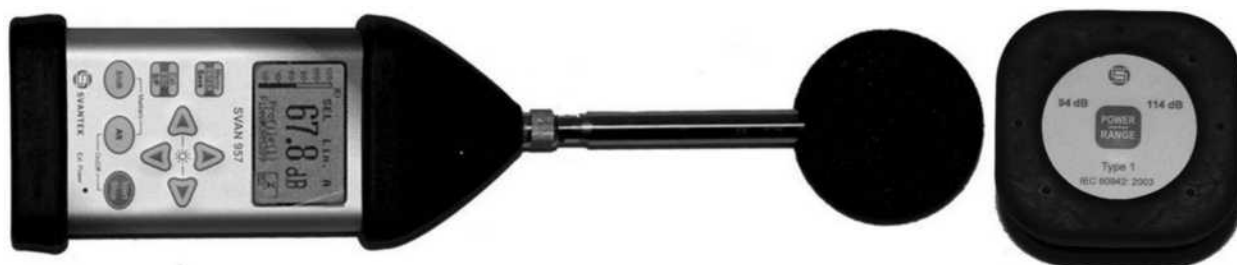
12 pav. SVAN 957 Triukšmo ir vibracijos matuoklis.
